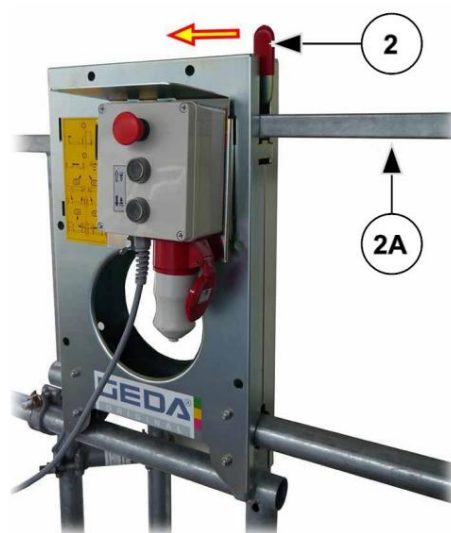
Fig. 70: Deschiderea/închiderea porții de siguranță la nivelul aterizării „Comfort”.
