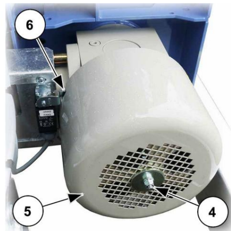
Fig. 104: Dispozitiv de siguranță cu întrerupător de limită
