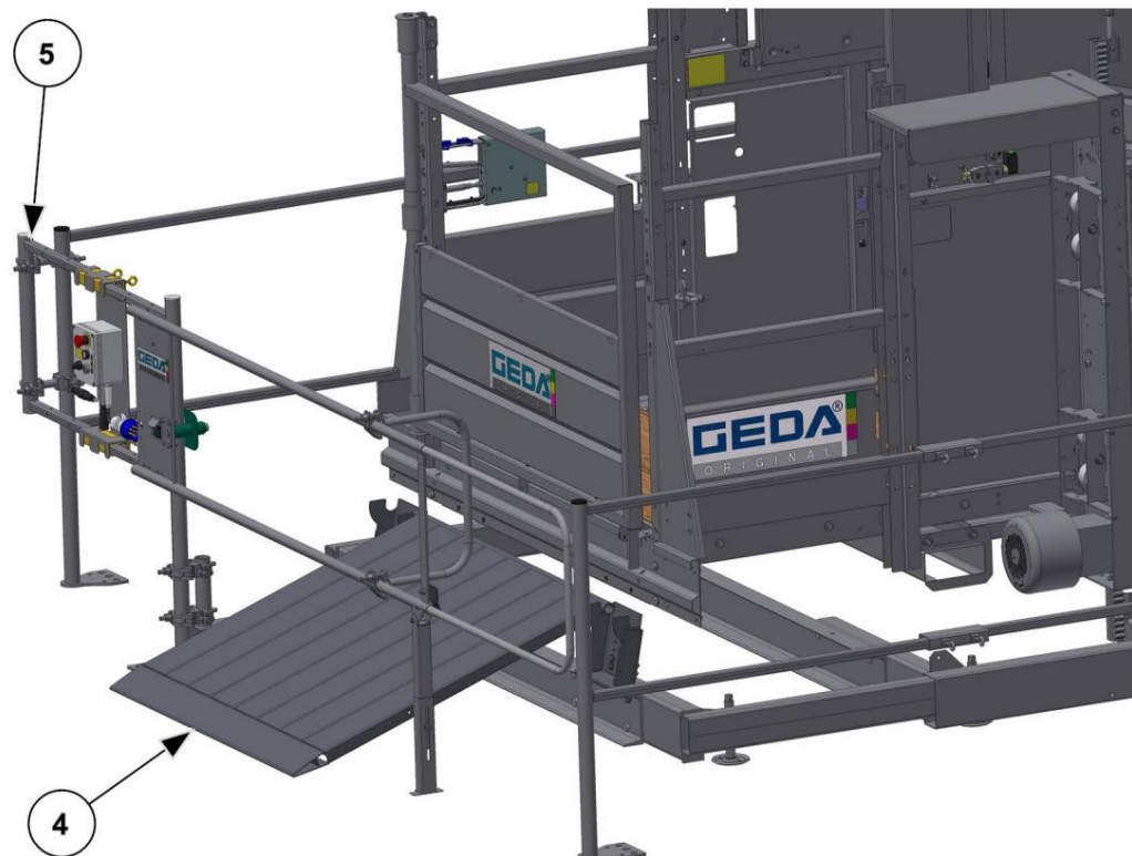
Fig. 50: Rampa de încărcare la accesul platformei stației de la sol
