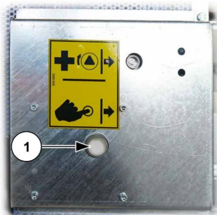
Fig. 40: Deblocarea încuietorului ușii glisante
