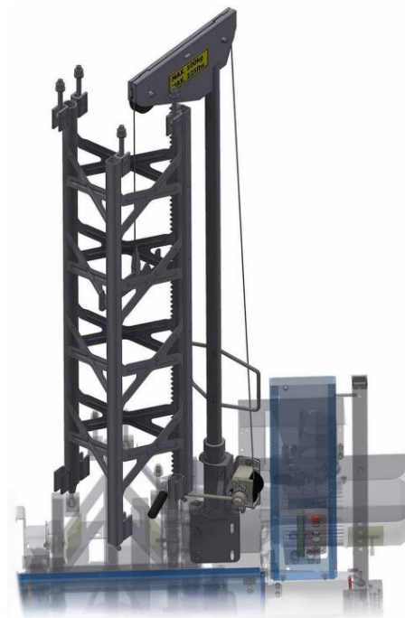
Fig. 97: Ridicarea, poziționarea pieselor catargului
