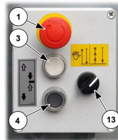
Fig. 79: Control la sol pentru incintă (AUTOMAT)
