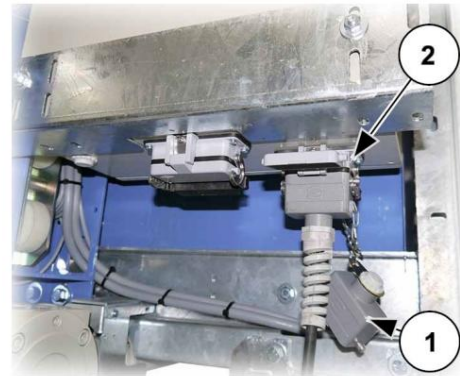
Fig. 102: Mufă falsă pentru controlul testului de cădere
