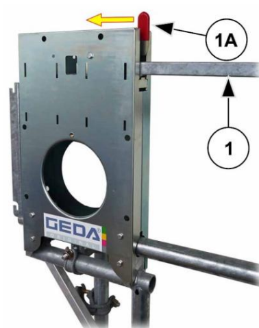
Fig. 65: Deschiderea/închiderea porții de siguranță la nivelul palierului „Standard”.
