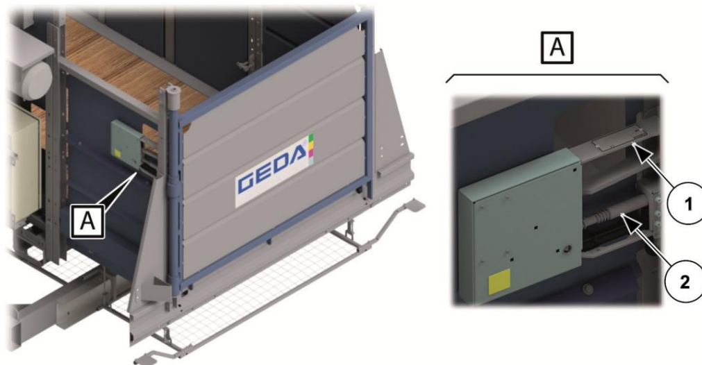
Fig. 47: Blocarea ușii de încărcare
